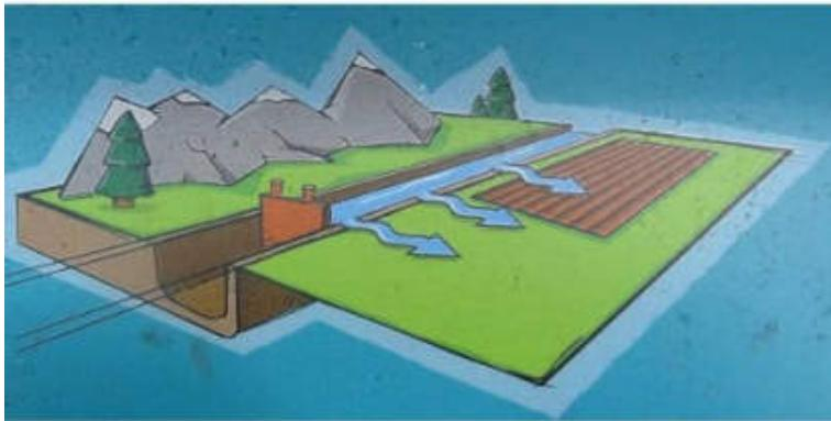
*Beregnung: in den Leitungen muss ein Mindestdruck von 3 atü erzeugt werden, damit eine Beregnung über die Ventile stattfinden kann. In steilem Gelände kann ein Druck auch natürlich erzeugt werden, in flachem Gelände braucht es Pumpen, die mit Elektroenergie angetrieben werden.*
