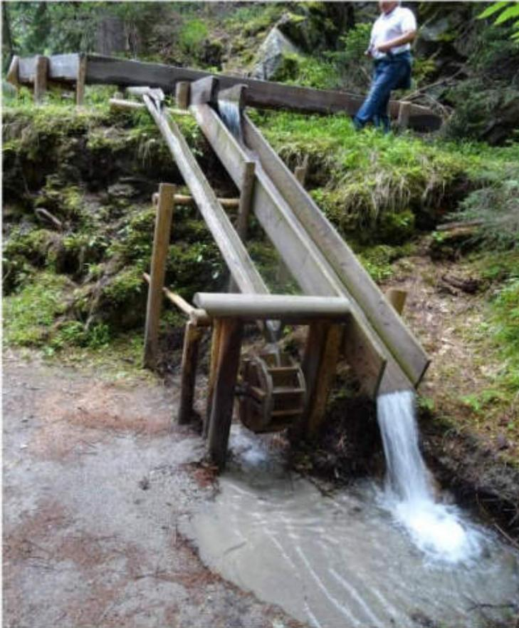
*Das Wasserrad kombiniert mit einer Glocke diente dem Waaler als Signal: der regelmäßige Klang der Glocke bestätigte den ungestörten Verlauf des Wasserwassers. Diese Anlage ist zum Spielen für Kinder gedacht.*
