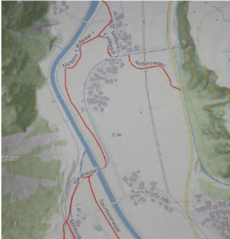
*Der Mittlere Fald-Waal 1 wird nordwestlich von Runhof am rechten Ufer der Öztaler Ache eingekehrt und verläuft an der Öztaler Ache entlang in Richtung Astlehn. Dort zweigt der Mittlere Fald-Waal 2 ab, der Astlehn bewässert. Der Mittlere Fald-Waal 1 setzt seinen Lauf in Richtung Norden fort und wird in die Öztaler Ache ausgekehrt.*
