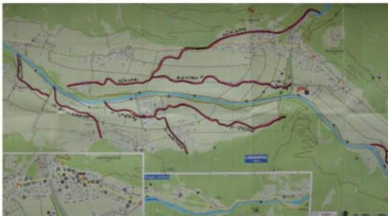
Auszug aus der ÖTZTAL-Karte „Längenfeld-Huben-Gries“ mit 6 händisch eingezeichneten Waal-Verläufen in der „Unteren Seite“. Die kerzengerade durch den Talboden ziehenden Entwässerungsgräben sind gut sichtbar.
