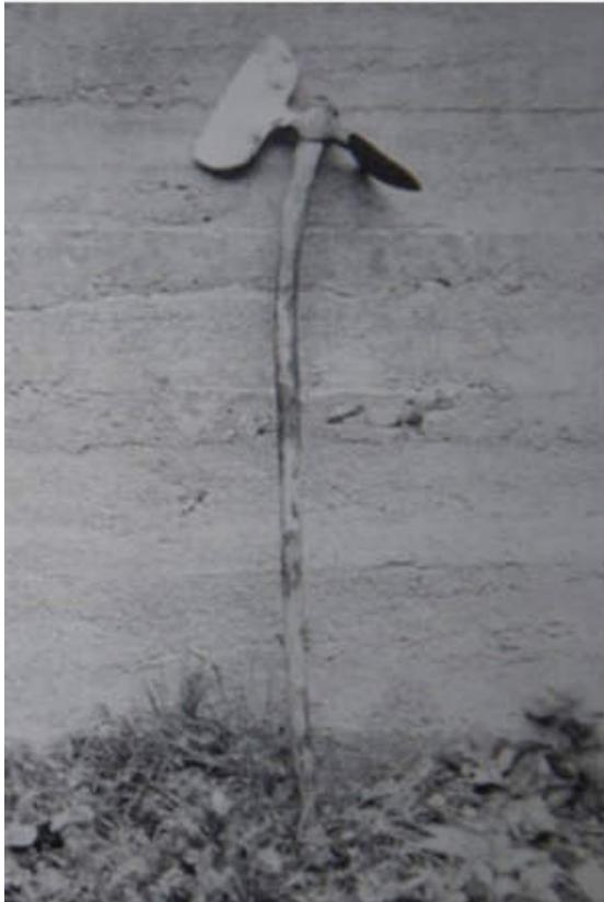
*Fig. 15 – Sölden im Ötztal. Der Schaft der „Waalhaue“ ist 123 cm lang, das Blatt der Axt ist 14 cm lang..*
