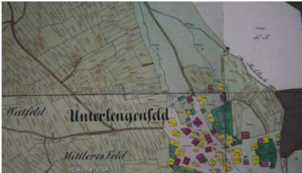
Auf der Franziszeischen Katasterkarte von 1856 kann man den Mühlwaal (wörtlich: MÜHLBACH) genau verfolgen: nach Einkehr am Fischbach und dessen Verlauf am nordöstlichen Rande von Unterlängensfeld zieht der Reatwaal=Mühlwaal=Mühlbach durch die Fluren in Richtung Dorf und dann westlich davon entlang der Ötztaler Ache bis zur Dorfer Au, wo wenig nördlich davon die Auskehr in die Ache stattfindet.
