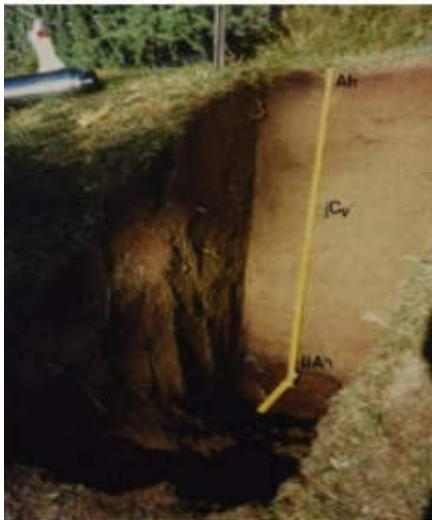
Aufnahme D. Lammerer (1997). „Grabung auf dem Grastalfeld im Horlachtal. Der natürliche, ehemalige Boden wird von einem 75 cm mächtigen, hellbraunen Sediment überdeckt, das durch die Berieselung aufgetragen wurde.“
